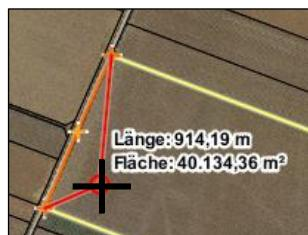
Während des Einzeichnens eines Polygons werden Daten von „Länge“ und „Fläche“ angezeigt.
